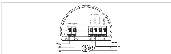
Отсек подключения (двухкамерный корпус)
